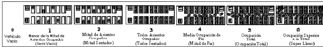
Figura 6-15 Cuadro de datos de ocupación para el estudio de Frecuencia y ocupación Visual Equivalencias: V = Van M = Microbús AC = Autobús corto AL = Autobús largo
