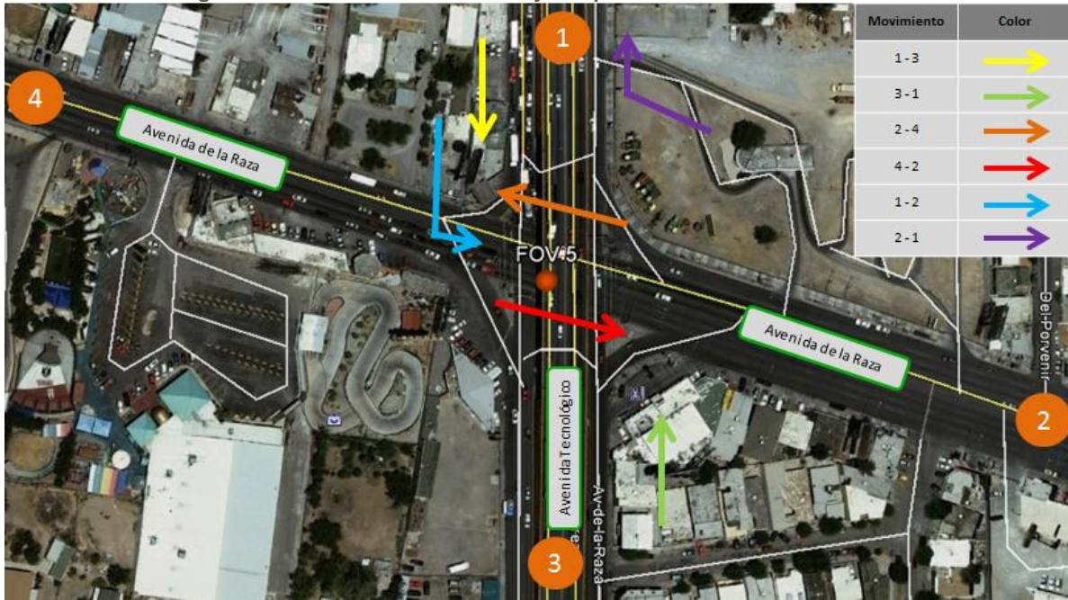
Figura 6-21 Estación 5 Frecuencia y Ocupación Visual Puesto Rotario
