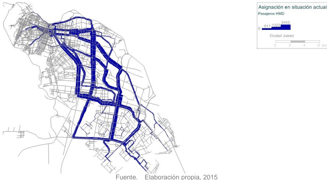
Figura 1-4 Asignación de viajes en el escenario base de calibración, hora pico de la mañana
